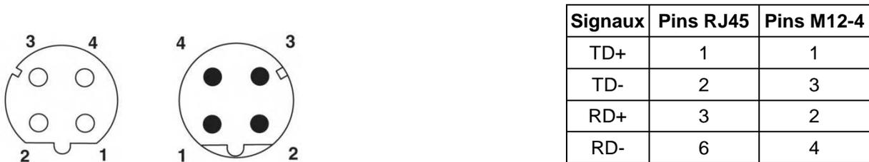
Figure 11 : Brochage du connecteur DIN M12
