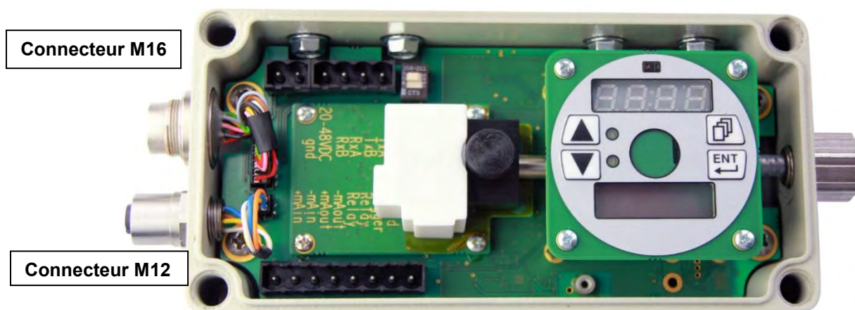
Figure 11 : Boîtier de traitement avec connecteurs M16 et M12.
